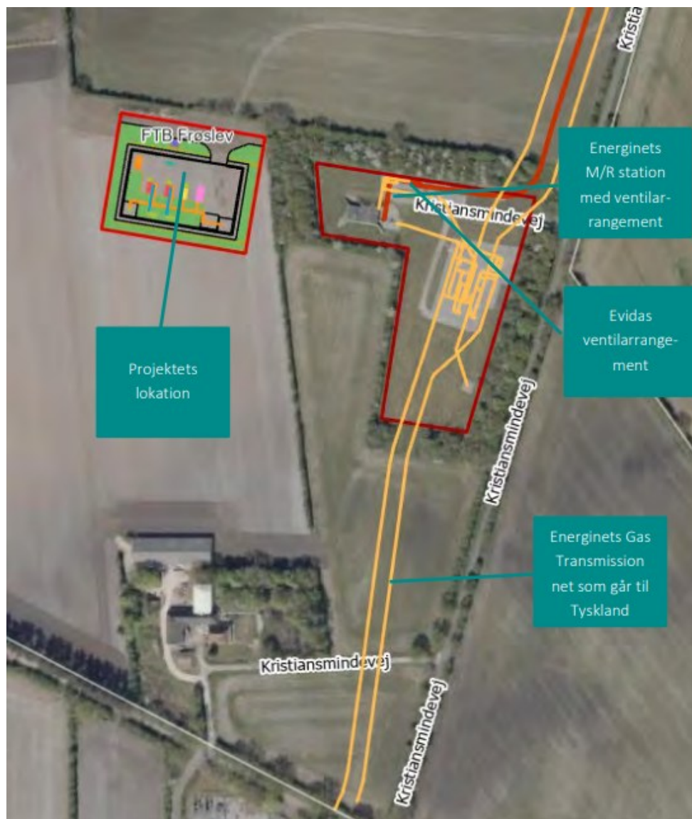
Figur 2 - Eksisterende anlæg og rørføringer nær projektets lokation. Bemærk at stationslayoutet ikke er retvisende på denne figur.
